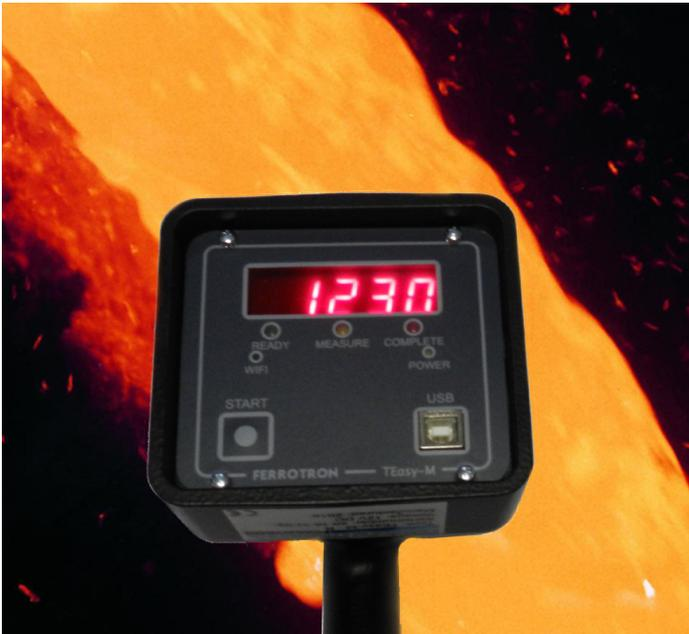
Das mikroprozessorgesteuerte Tauchtemperatur-Messgerät **FERROTRON TEasy-M** eignet sich besonders für kleinere und mittlere Metallschmelzen in Öfen, Pfannen und Kokillen.
